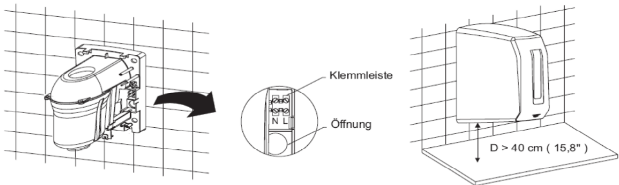
Position der Klemmleiste und der Ø22 mm – Öffnung für die Kabel
