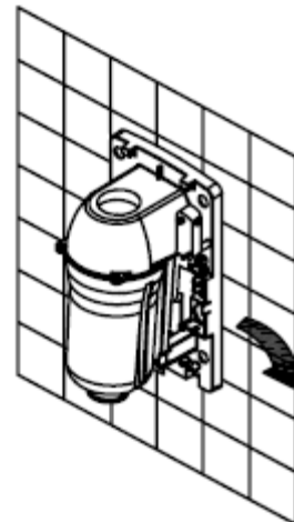
Emplacement de la réglette et du trou Ø22 d'entrée des câbles
