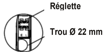
Emplacement de la réglette et du trou Ø22 d'entrée des câbles
